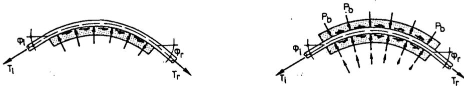
図-4. 2. 15 カバーなしサドルに作用する摩擦力
