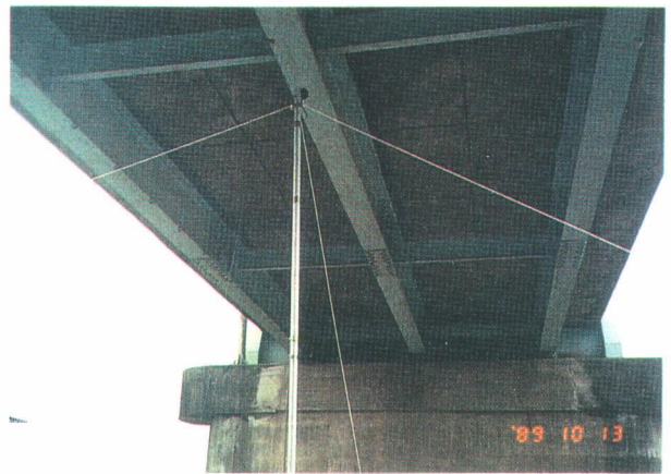
写真-8 低周波音レベル計設置状況
