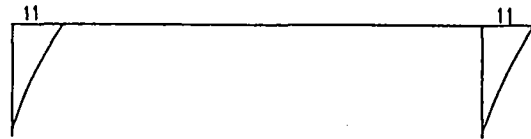
地震時横力のみによる変形を示す
