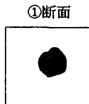
図4-3-4 切断試験による欠陥7の断面スケッチ (倍率10)
