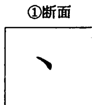
図4-3-3 切断試験による欠陥6の断面スケッチ (倍率10)
