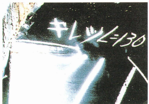
写真 4.98 連結板接触による溶接部のわれ
