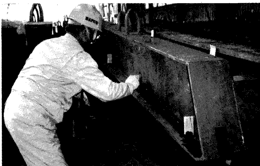
写真 2. 4 先行刷毛塗り作業
