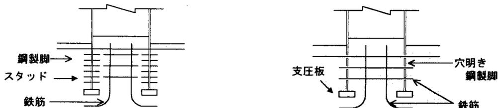
図-4.5.1 スタッド、有孔鋼板による直接埋込み方式
