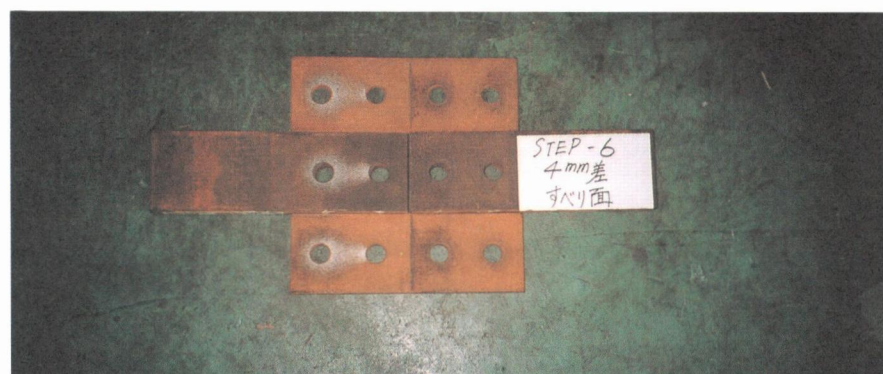
写真一14 試験結果 (SM490Y : 板厚差 4mm 赤錆)
