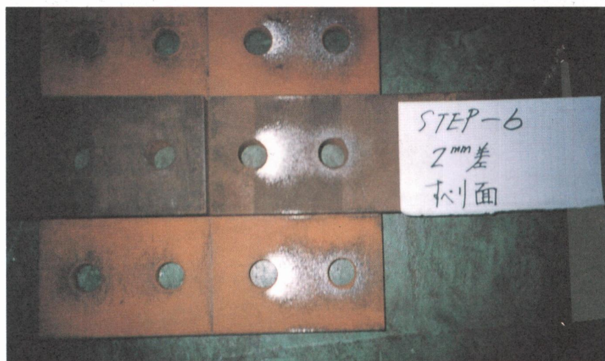
写真一13 試験結果 (SM490Y : 板厚差 2mm 赤錆)
