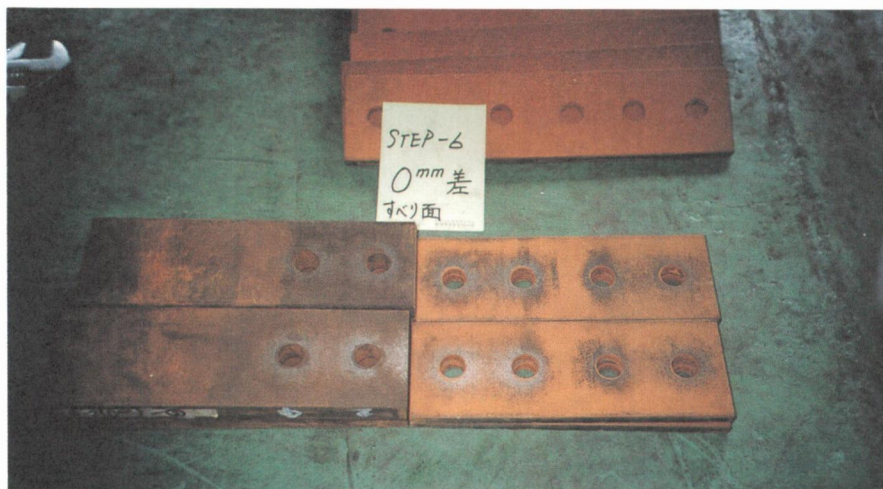
写真一12 試験結果 (SM490Y : 板厚差 0mm 赤錆)
