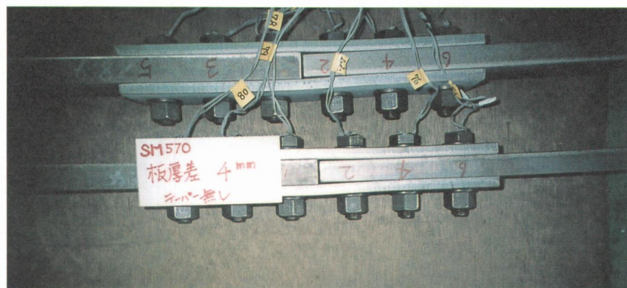
写真一9 試験体写真 (SM570 : 板厚差 4mm)
