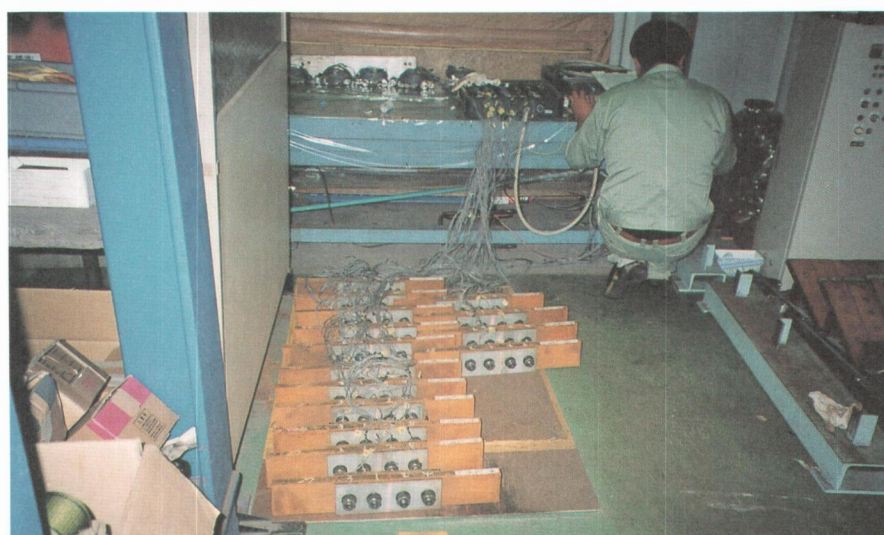
写真一 2 試験体軸力測定状況
