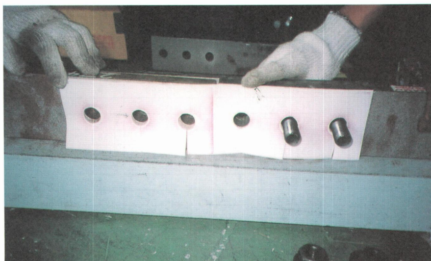
写真一 3 接触厚測定状況 (感圧紙)
