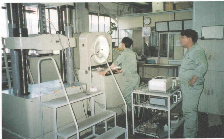
写真一 5 滑り試験状況
