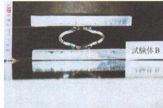
図-3.3.31 b 静的圧縮荷重における変形形状の推移 (タイプB)
