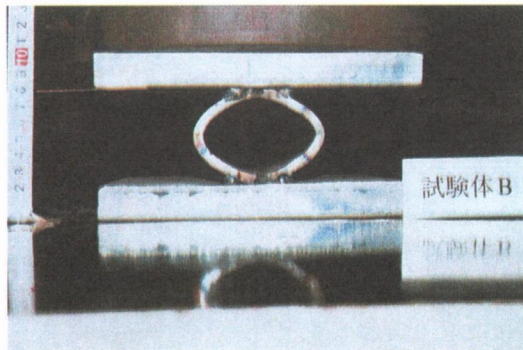
図-3.3.31 a 静的圧縮荷重における変形形状の推移 (タイプB)
