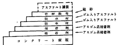
(d) 塗膜系防水層(アスファルト加熱型)
