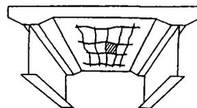
④下面から発生した曲げクラックが移動荷重の影響で上面まで貫通する段階
