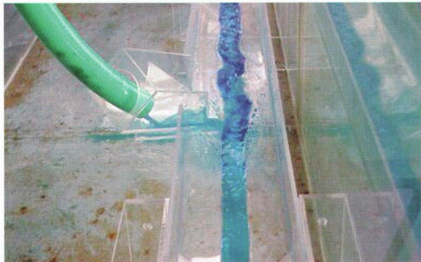
5角形断面における土砂堆積実験
