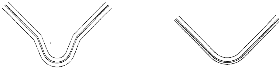
(a) カモメ状の変形(上下等厚の場合) (b) 上下不等厚の使用により変形しない例
