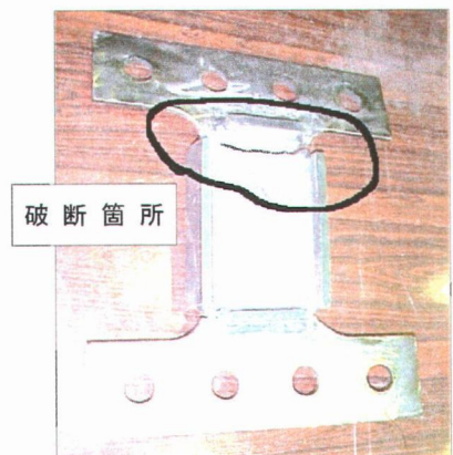
図 3-3-38 せん断型供試体
