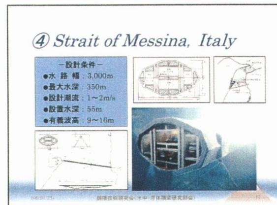
水中橋梁の設置位置は沈埋トンネルのように海底に着底しておらず、浮体橋梁のように海面上に浮いているものでもない。それ故、橋梁基礎の設置が困難なほどの水深の深い場所にも建設が可能なこと、水深が急激に深くなっているような場所（フィヨルド等）ではトンネルのように長いアプローチが不要になること、距離が長くなるほど橋梁に比べてコストが安くなること、航路幅の広いところにも適していること等が特徴として挙げられる。
