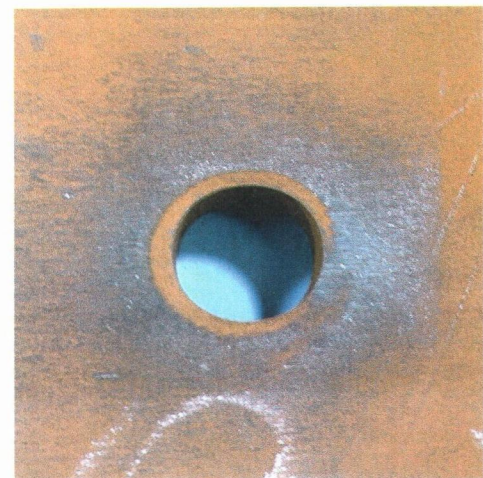
(a) 全体写真 写真-3.6 試験後の摩擦面の状況 [赤錆面(1週間海岸部曝露)]
