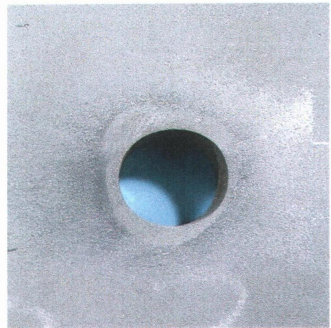
(a) 全体写真 写真-3.5 試験後の摩擦面の状況 [ショットブラスト Sa2(軽い)]
