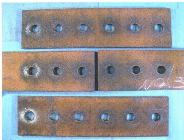
(a) 全体写真 写真-3.6 試験後の摩擦面の状況 [赤錆面(1週間海岸部曝露)]
