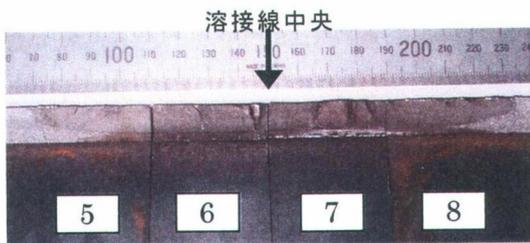
写真 4-13 疲労破面
