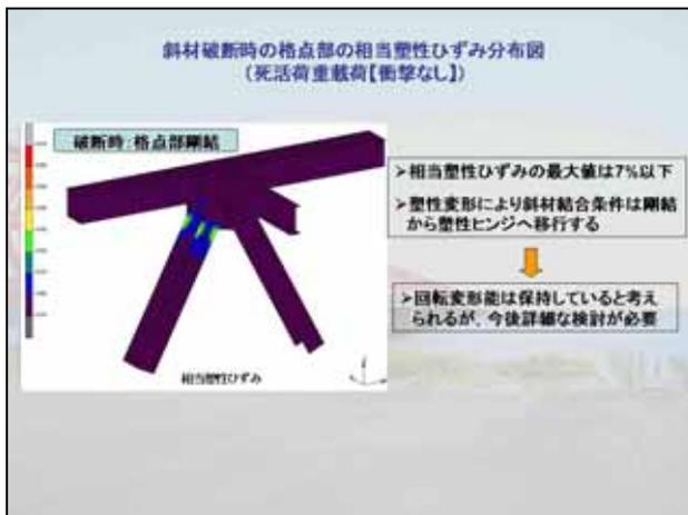
こちら図は、格点部の結合条件が剛結で斜材に塑性化が生じた場合の相当塑性ひずみを示しております。塑性ひずみの最大値は7%以下ですので、破断することはないと判断されます。また、塑性化による変形の増大により、斜材の結合条件は剛結からピン結合には移行し、回転変形性能は、保持していると考えられます。ただし、この格点部の変形性能に関しては、今後詳細な検討が必要であると
