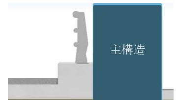
図5 下路橋の車両防護柵の例
