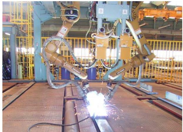
写真-2.2 ガスシールド溶接を利用した溶接ロボット
