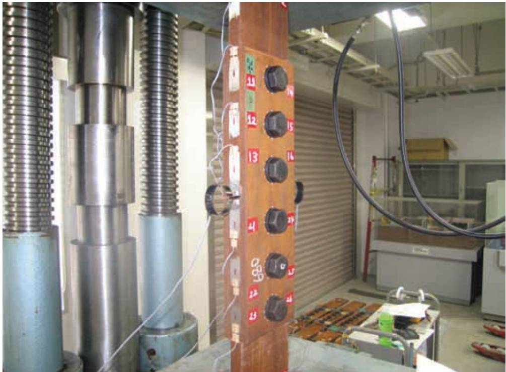
写真-2.5 ゲージ貼付状況
