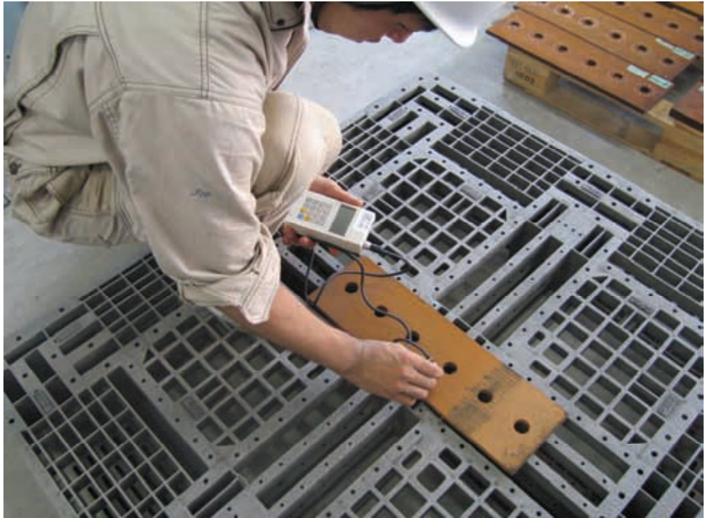
写真-2.3 鍍厚測定状況
