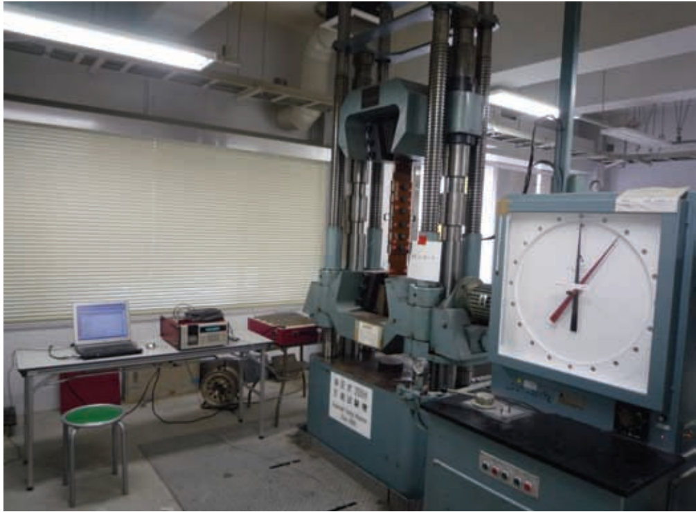
写真-2.4 試験体のセット状況
