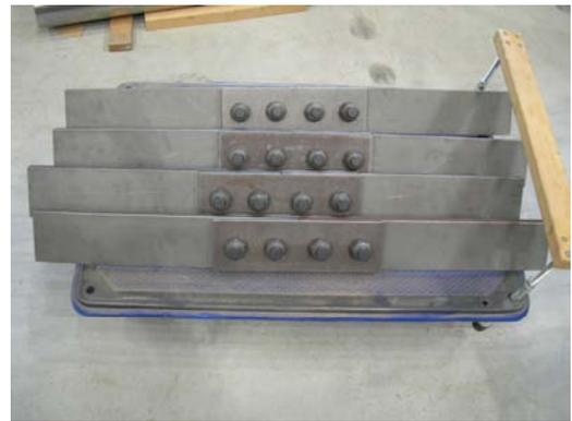
写真-18 すべり試験体
