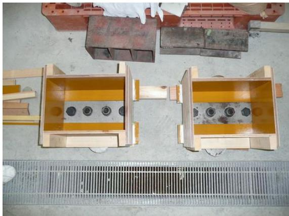
写真-8 型枠作成後
