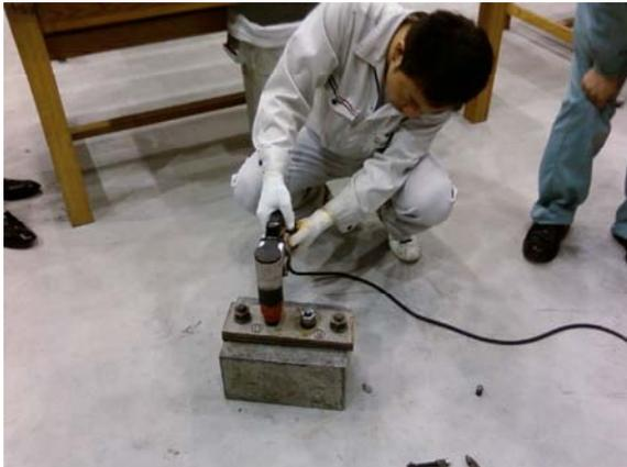
写真-11 専用シアレンチでボルト締結
