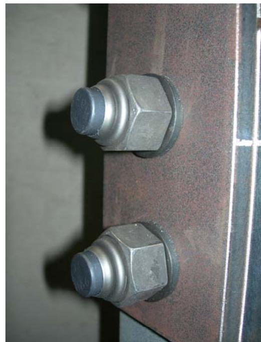
写真-2 4 すべり後のナット側状況
