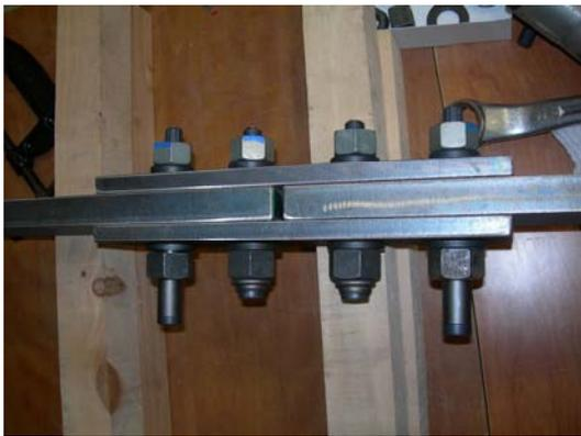
写真-17 ワンサイド高力ボルト締結中
