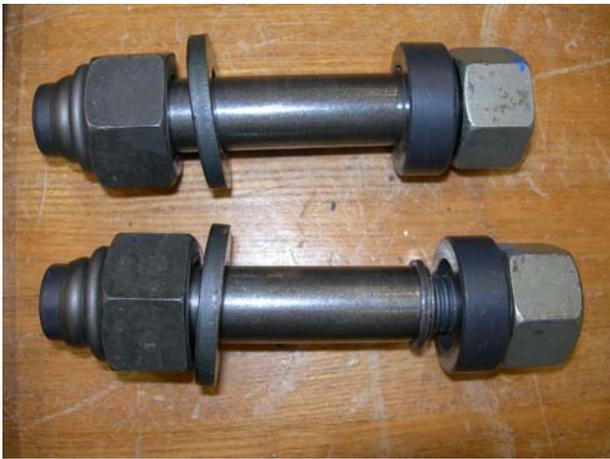
写真-26 すべり発生後のワンサイド高力ボルト状況
