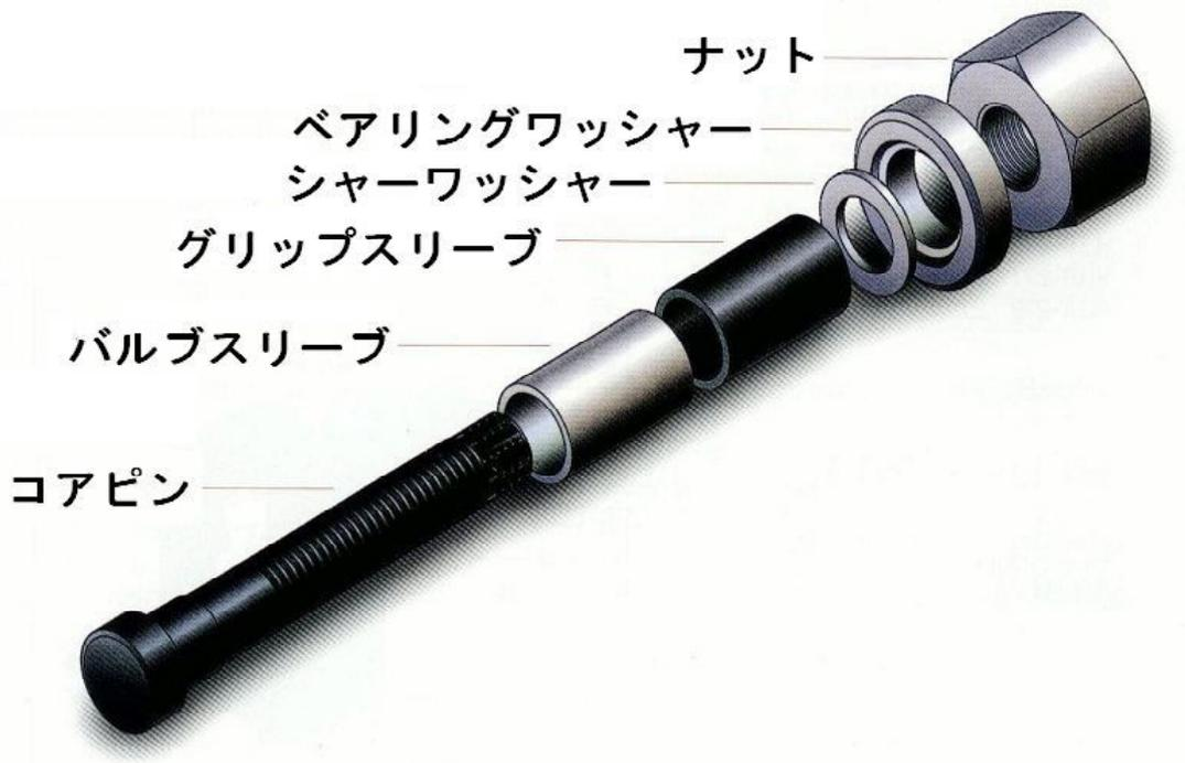
図-1 ワンサイド高力ボルトの部品構成図（6部品構成）
