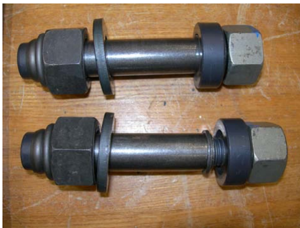
写真-26 すべり発生後のワンサイド高力ボルト状況
