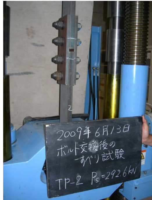
写真-2 2 すべり荷重 P_{s2} = 292.6\text{knN} 摩擦係数 \mu_2 = 0.504
