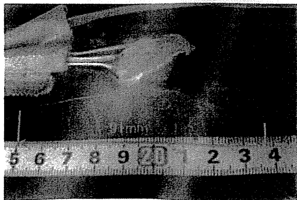
写真-14 垂直補剛材（180×14）側 デッキプレート上面き裂（載荷数400万回）
