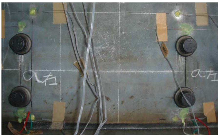
写真-9 ワンサイドボルト (バルブスリーブ側)
