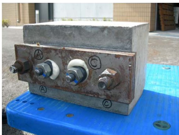
写真-13 樹脂注入後
