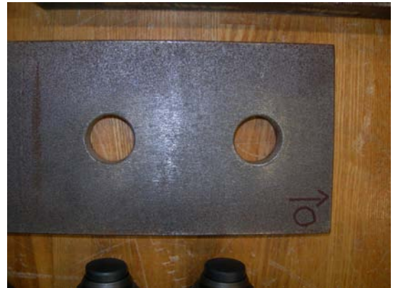
写真-25 すべり発生後の添接板表面状況
