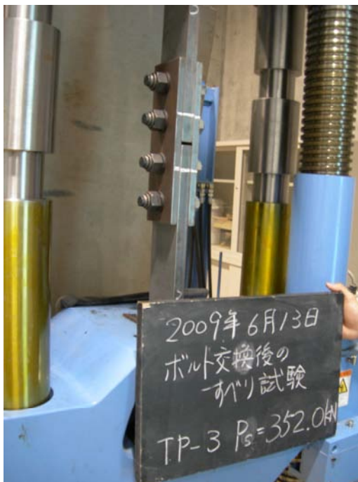
写真-2 3 すべり荷重 P_{s3} = 352.0\text{knN} 摩擦係数 \mu_3 = 0.607
