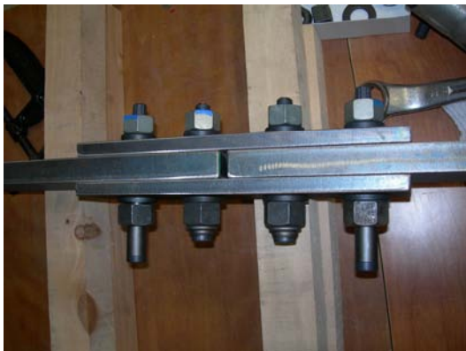
写真-17 ワンサイド高力ボルト締結中
