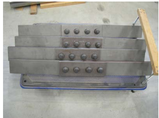
写真-18 すべり試験体
