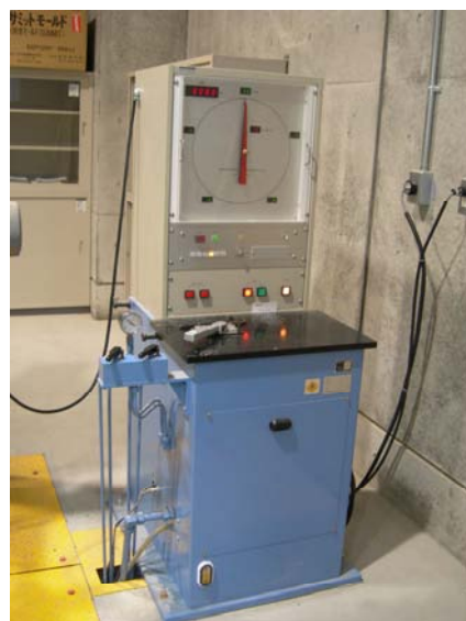
写真-20 1000kN アムスラー試験機
