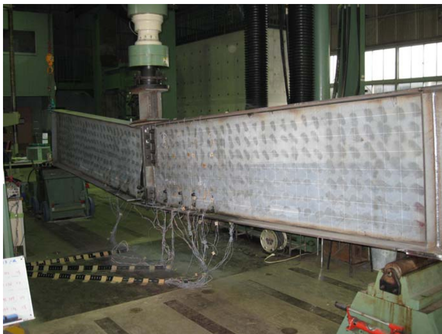
写真-20 鋼桁破断全景
