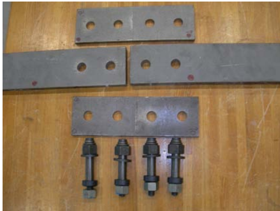
写真-25 すべり発生後の添接板表面状況
