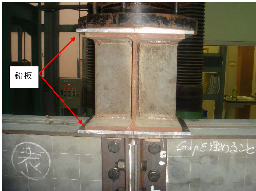
写真-3 載荷点下の荷重伝達治具と鉛板
