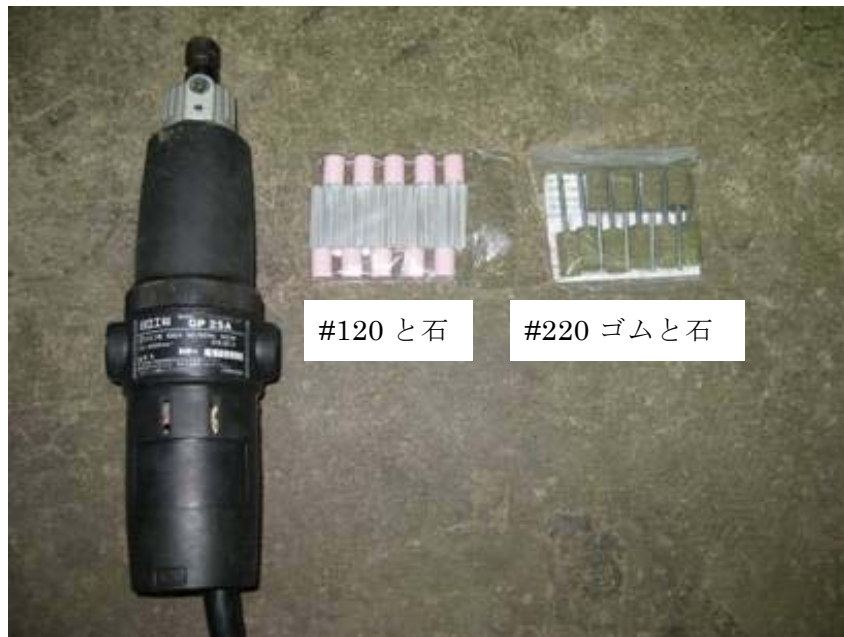
写真-6 孔壁の曲面仕上げに使用したグラインダ、と石
