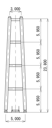
図 4-2 主塔断面図
