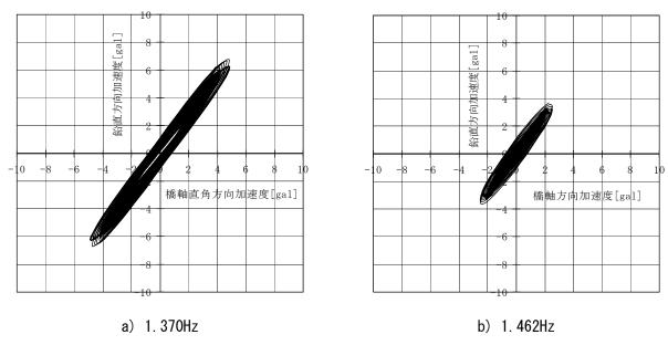
図 4-46 各固有振動数でバンドパスフィルタによって分離した加速度のリサージュ図 (50~150sec)
