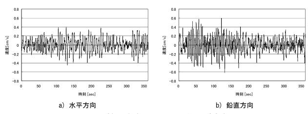
図 4-12 橋面 L/4 点 (Node 03) における速度波形
