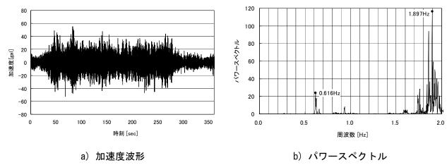
図 4-17 橋面 L/4 点 (Node 3) における鉛直方向の加速度波形とパワースペクトル
