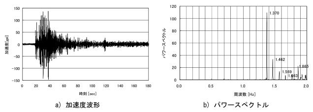
図 4-44 耐風索 (Node 14) における鉛直方向の加速度波形とパワースペクトル
