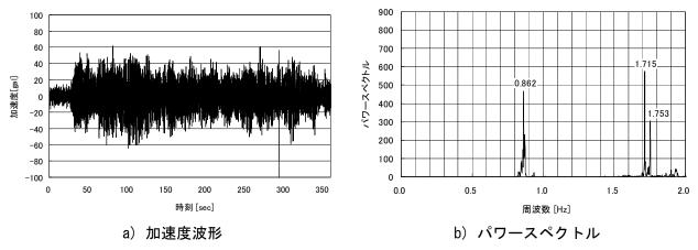
図 4-25 橋面 L/4 点 (Node 3) における鉛直方向の加速度波形とパワースペクトル
