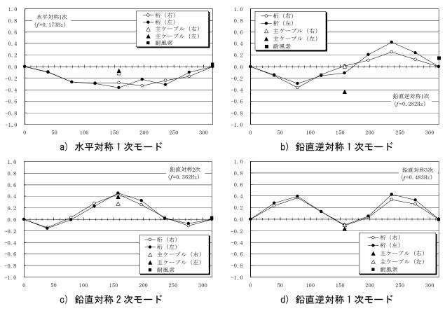
図 4-14 常時微動から推定された固有振動モードと固有振動数
