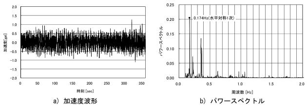
図 4-10 橋面 L/4 点 (Node 03) における水平方向の加速度波形とパワースペクトル
