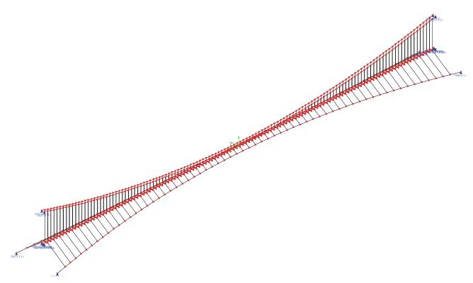
図 4-9 立体骨組構造解析モデル
