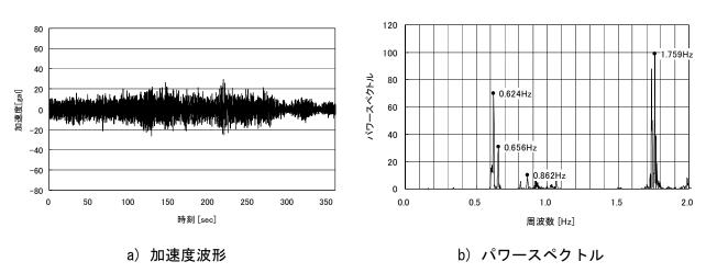
図 4-16 橋面 L/4 点(Node 3)における水平方向の加速度波形とパワースペクトル
