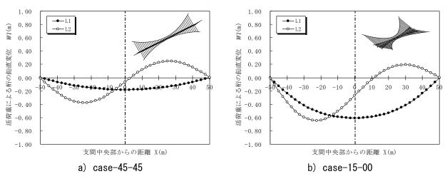
図 2-9 耐風索ありモデルにおける桁の鉛直変位分布
