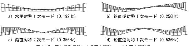
図 4-15 固有振動解析による固有振動モードと固有振動数
