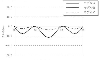
図 3-5 補剛桁たわみ図 (CASE-1)
