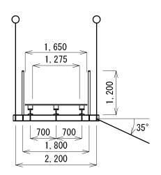
図 4-3 桁断面図
