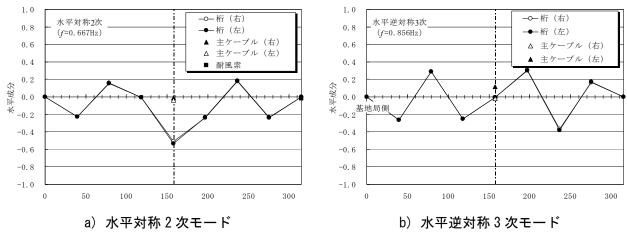
図 4-23 歩行パターン A から推定した振動モード
