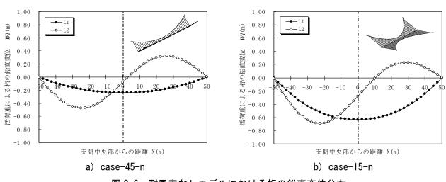
図 2-6 耐風索なしモデルにおける桁の鉛直変位分布
