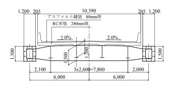
図 3-2 断面図(単位:mm)
