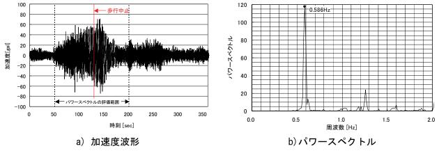
図 4-32 桁 L/4 点(Node 15)における鉛直方向の加速度波形とパワースペクトル
