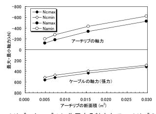
図 3-14 アーチリブ、ケーブルに作用する軸力とアーチリブの断面積の関係
