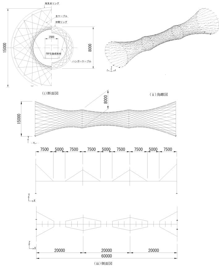
図 4-4 構造図(支間長:60m)
