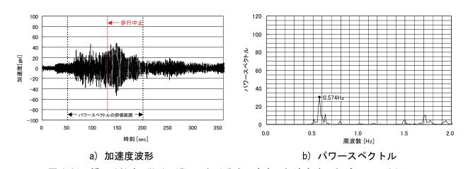
図 4-31 橋面 L/4 点 (Node 15) における水平方向の加速度波形とパワースペクトル
