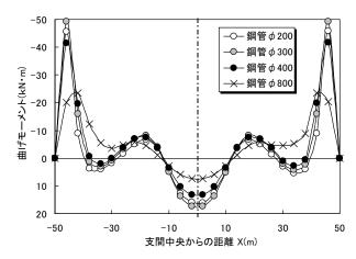
図 3-9 主桁の曲げモーメント分布
