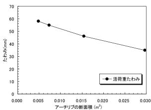
図 3-6 活荷重満載時における主桁のたわみ分布
