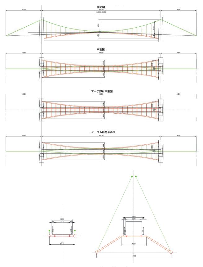
図 3-3 アーチ併用吊橋の形状図
