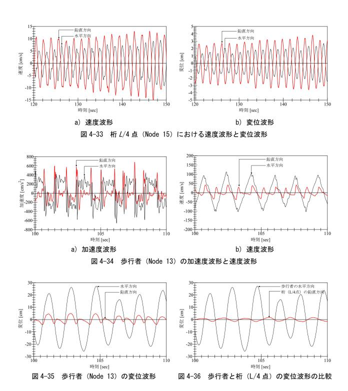
さらに、歩行パターン C の計測データより、卓越する固有振動数に対する振動モードの推定を行った。推定は、ERA によった。図 4-37 に推定された振動モードを、また、図 4-38 に固有振動解析による固有振動モードを、それぞれ示す。図より、ねじり逆対称 1 次モード (0.585Hz) であることがわかり、解析結果による固有振動数もほぼ同程度であることが確かめられた。図 4-33 b)からは、桁は水平方向にも変位していたが、振動モードは特定できなかった。固有振動数はほぼ同じであることから、この水平成分についても連成振動の影響が考えられた。本橋では耐風索が設置されており、ねじり振動に伴って、水平方向にも変位することも考えられる。
