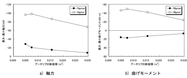
図 3-10 主桁に作用する最大・最小断面力の比較
