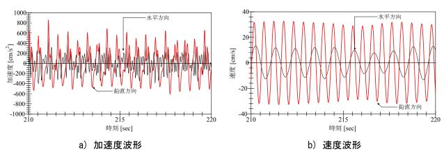
図 4-20 歩行者 (Node 13) の加速度波形と速度波形
