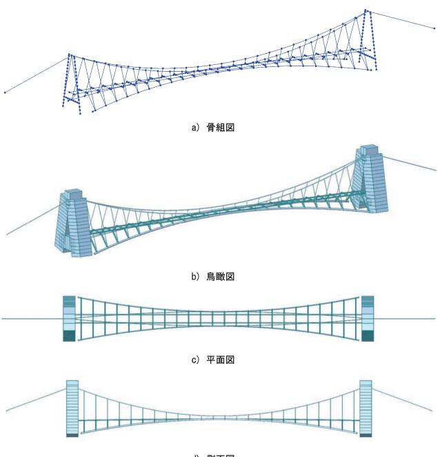
d) 側面図 図 3-4 アーチ併用吊橋のモデル図
