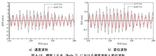
図 4-18 橋面 L/4 点 (Node 3) における速度波形と変位波形
