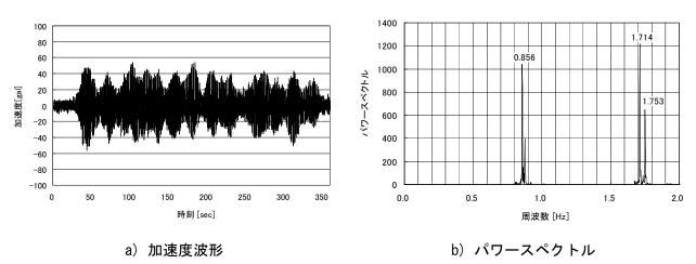
図 4-24 橋面 L/4 点 (Node 3) における水平方向の加速度波形とパワースペクトル
