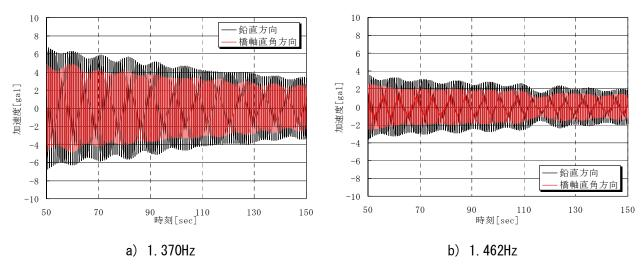
図 4-45 各固有振動数でバンドパスフィルタによって分離した加速度波形の比較
