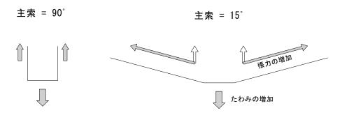
図 2-17 主索角度と構造特性の概念図
