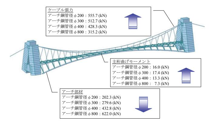
図 3-5 各部材の断面力の推移
