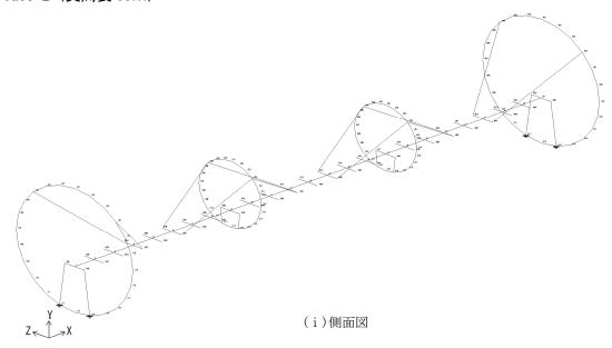
図 4-6 モデル図(支間長:60m)
