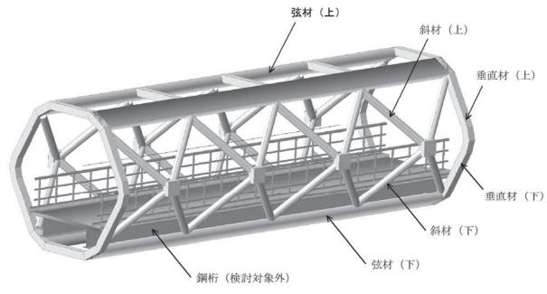
※上図は構造検討中のモデル図であるため、中段弦材および中間格点部の垂直材が含まれていない。
