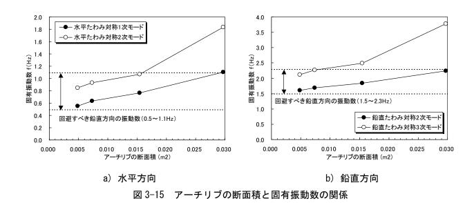
まず、表 3-3 より、橋梁全体系の固有振動モードは、水平方向と鉛直方向で 2 つずつ算定された。それらは、全てのケースで、最低次から水平たわみ対称 1 次モード、水平たわみ対称 2 次モード、鉛直たわみ対称 2 次モードおよび鉛直たわみ対称 3 次モードであった。アーチリブの断面剛性が大きくなるほど、固有振動数が増加することがわかる。
