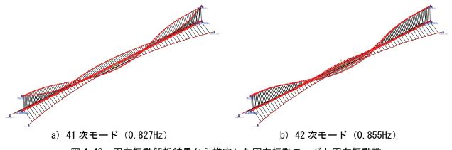
図 4-43 固有振動解析結果から推定した固有振動モードと固有振動数
