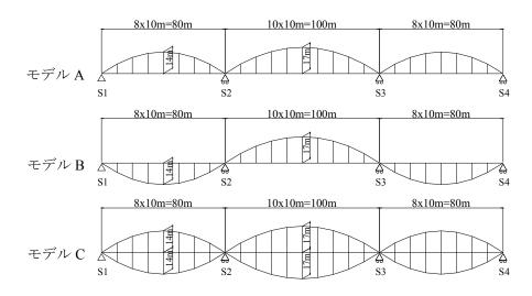
図 3-1 解析骨組み図 (側面図)
