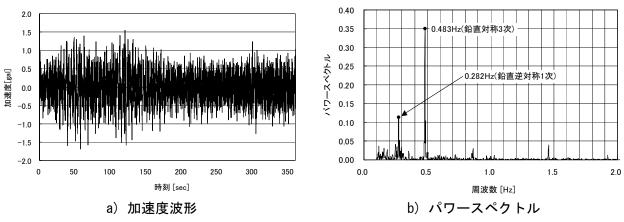
図 4-11 橋面 L/4 点 (Node 03) における鉛直方向の加速度波形とパワースペクトル
