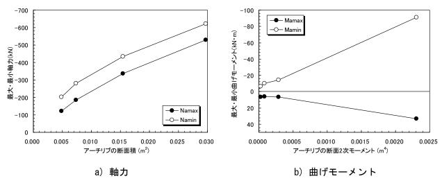
図 3-13 アーチリブに作用する最大・最小断面力と断面剛性の関係
