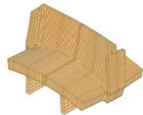
(d) タイプ 3 (底板厚 27mm, 立板厚 12mm)
