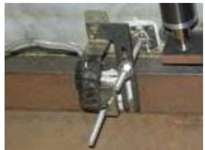
写真 4-3-5 クリップゲージ設置状況
