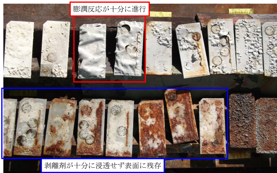
図 3-18 剥離剤塗布後 90 時間経過時の試験体
