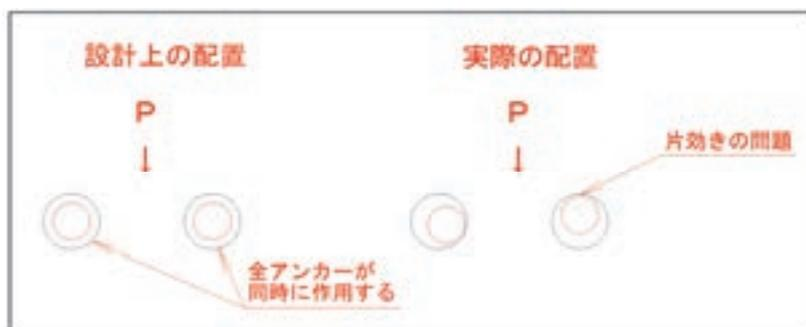
図 3-3-1 アンカーボルトとアンカー孔の位置関係
