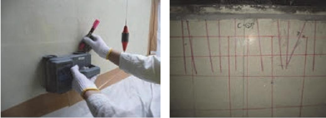
図 2-2-4 鉄筋探査
